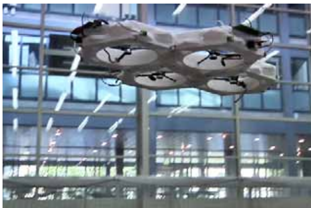
Nur wenn diese an der ETH Zürich entwickelten Propeller-Vehikel sich miteinander verbinden, können sie zusammen vom Boden abheben. (Siehe www.idsc.ethz.ch ; Projekt Distribute Flight Array).
